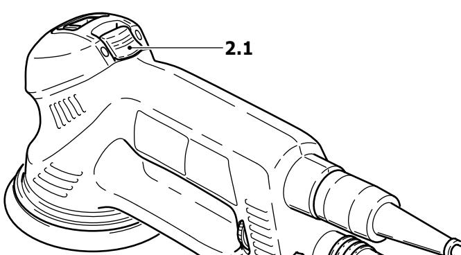
Pour mettre l'outil en marche, appuyez sur l'interrupteur (2.1) et poussez-le vers l'avant jusqu'à ce qu'il s'encliquette. Pour l'arrêter, appuyez sur l'interrupteur - ce dernier se déverrouille et revient à la position « OFF ».
