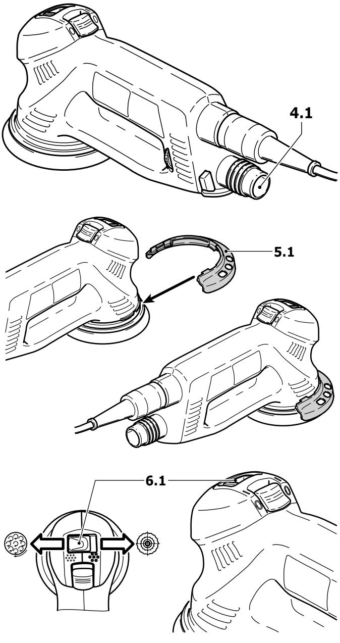
Ud. puede conectar un aparato de aspiración Festool con una manguera de aspiración con un diámetro 27 mm al puerto de extracción de polvo (4.1).
