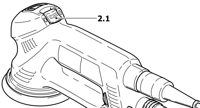
Para poner en marcha la máquina, pulse el interruptor (2.1) hacia abajo y hacia delante hasta que encaje. Para apagarla, pulse el interruptor hacia abajo: de este modo se desbloquea el interruptor y vuelve a la posición de apagado.
