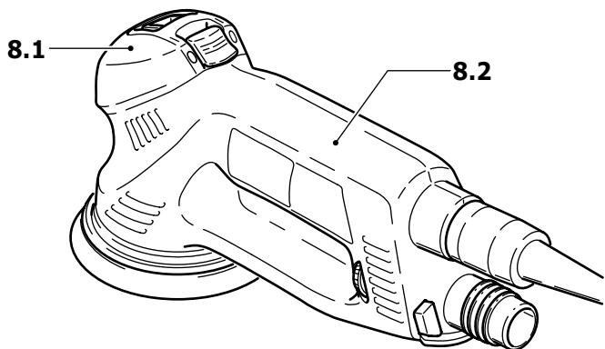
Sujete la máquina para un guiado seguro con una mano sobre la carcasa del motor (8.2) y la otra sobre el cabezal del engranaje (8.1).
